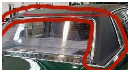
13: Bestreichen Sie die Rückseite des Dachbezuges mit dem Kleber sehr gleichmäßig und dünn, am besten mit einem Pinsel. Während der Arbeiten kann der Kleber auf der Rückseite des Vinyl Dachbezuges trocknen, das ist kein Problem.
